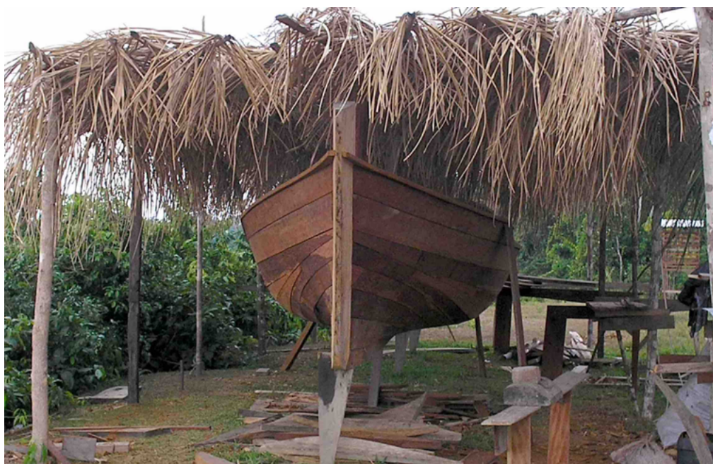
Figura 01. Fabricação artesanal de Batelão. Fonte: Arquivo da COMARU, 2011.
