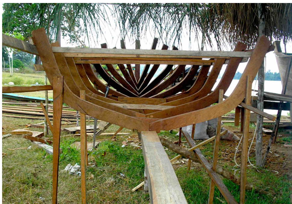
Figura 02. Fabricação artesanal de estrutura de Batelão. Fonte: Arquivo da COMARU, 2011.
