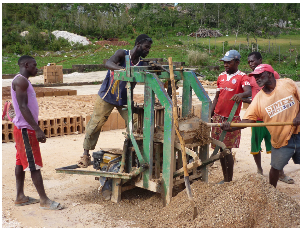
A máquina (prensa) que produz os blocos, a partir de pouco cimento e muita areia.
